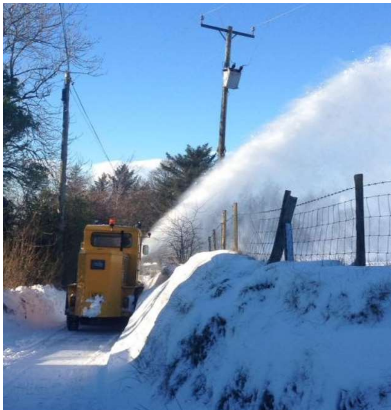
Ffigur 15 – Chwythwr eira Rolba wrth ei waith. Defnyddir chwythwyr eira mewn amodau eithafol i glirio eira.
